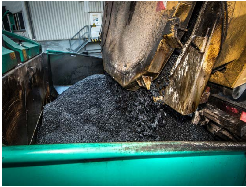
Bild 2: Kaum Anbackungen aufgrund der guten Ablaufstabilität des Asphaltes mit Additivzusatz
